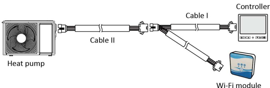
Bitte trennen Sie das Kabel über die Stecker von der Steuerung und der Platine. Kabel II ist mit dem Leiterplattenkabel verbunden und mit Steuerung I verbunden. Stecken Sie bitte das Kabel II und die Stecker zwischen Kabel II und Kabel I in das Wärmepumpengerät.
