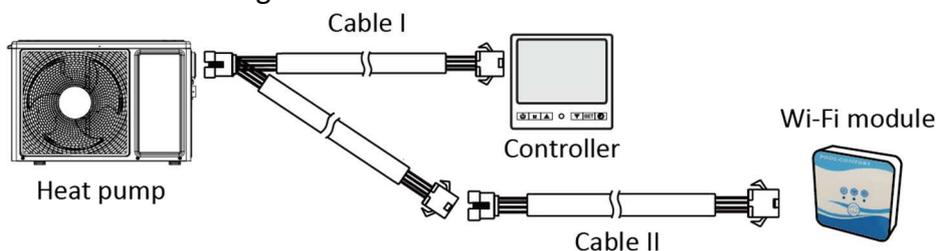
Bitte trennen Sie das Kabel über die Stecker von der Steuerung und der Platine. Das I-Kabel wird mit dem Leiterplattenkabel verbunden und stellt die Verbindung zur Steuerung und zum WLAN-Modul her. Nach dem Anschluss stecken Sie bitte das I-Kabel und das Steuerkabel einschließlich der Stecker in das Wärmepumpengerät.
