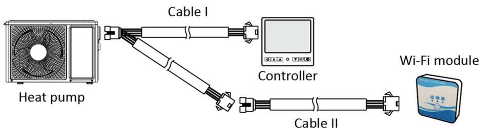
Por favor, desligar o cabo do controlo e o PCB através dos conectores. O cabo I liga-se ao cabo PCB e liga-se ao controlo e ao módulo Wifi. Após a ligação, colocar por favor o cabo I e o cabo de controlo incluindo os conectores na unidade da bomba de calor.
