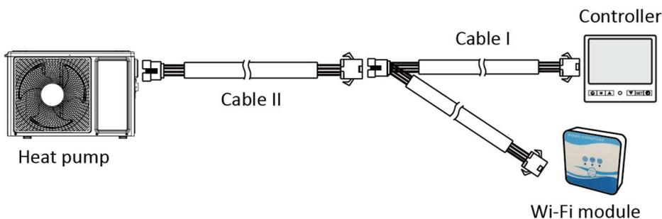
Por favor, desligar o cabo do controlo e o PCB através dos conectores.
