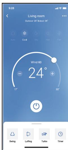
③ Así, el usuario podrá controlar el encendido/apagado del aire acondicionado, el modo de operación, la temperatura, la velocidad del ventilador y otros.
