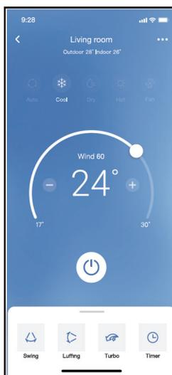
③ Ainsi, l'utilisateur peut contrôler l'état de marche/arrêt des climatiseurs, le mode de fonctionnement, la température, la vitesse du ventilateur, etc.
