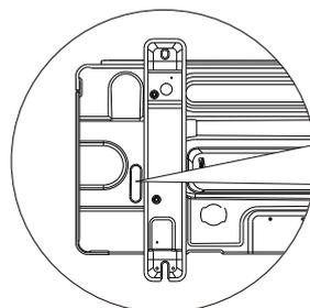
Ce trou de vidange est recouvert d'un bouchon en caoutchouc. Si le petit trou de vidange ne peut pas répondre aux exigences de vidange, le grand trou de vidange peut être utilisé en lieu et place.
