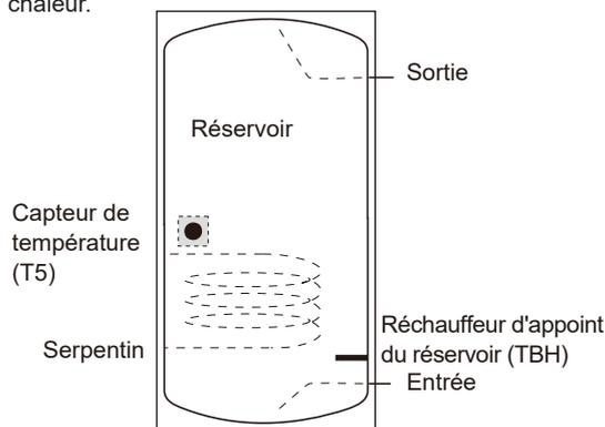
Le réchauffeur d'appoint doit être installé sous la sonde de température (T5).
