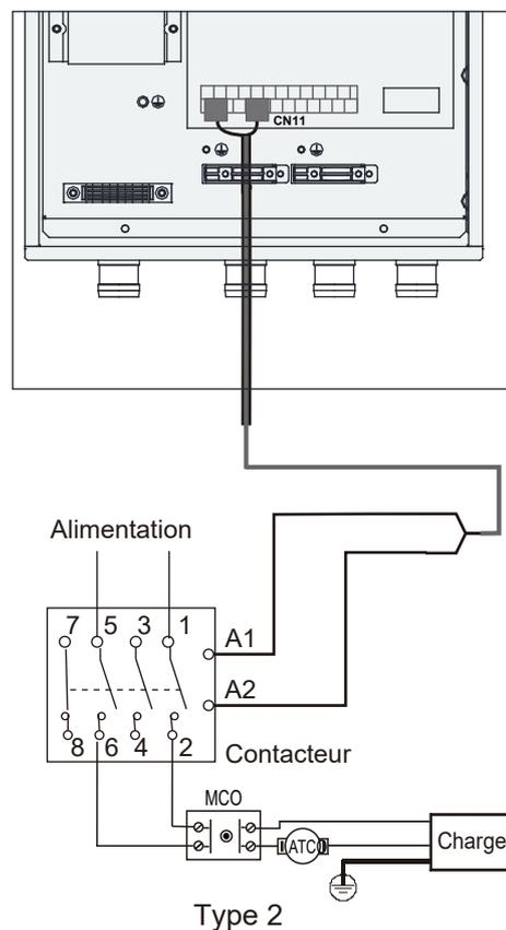
Port du signal de commande du module hydraulique : Le CN11 comporte des bornes pour la vanne à 3 voies, la pompe, le chauffage d'appoint, le réchauffeur, etc.
