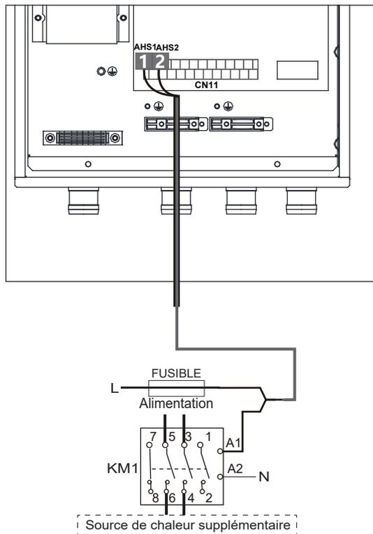
Le câblage entre le boîtier électrique et la plaque arrière est illustré au point 7.5.2 Câblage de l'alimentation principale.
