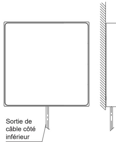
Sortie de câble côté inférieur
