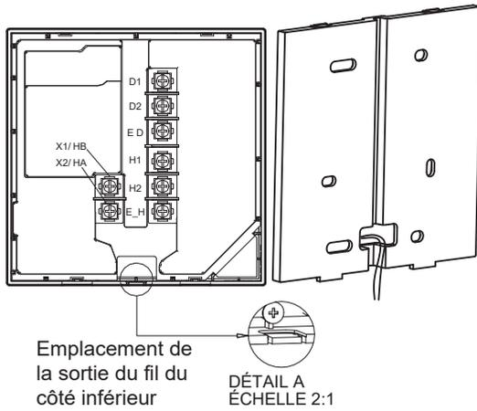
Emplacement de la sortie du fil du côté inférieur
