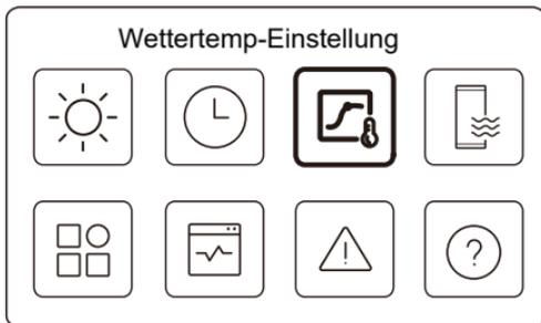
Die Soll-Wassertemperatur wird automatisch in Abhängigkeit von der Außentemperatur geregelt.
