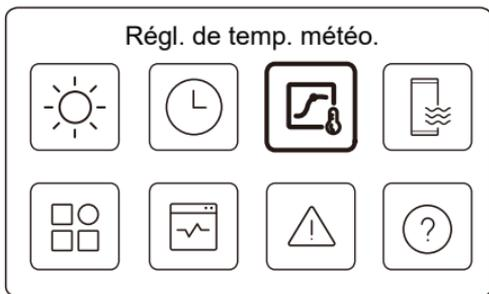
La température de l'eau est réglée automatiquement en fonction de la température ambiante extérieure.
